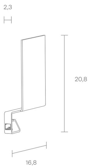
Die FNP Buchstütze wird auf das Regal-Tablar aufgeschoben und bietet anlehnsbedürftigen Büchern den nötigen Halt. Die Buchstütze kann jederzeit den Platz wechseln oder entfernt werden.
