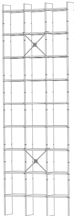
FNP X Fix und FNP X12 Fix stabilisiert freistehende Regale, realisiert Tür-Überbauten und ähnliche (auch freistehende) Brückenkonstruktionen. Kann nur an Innenfächern montiert werden.
