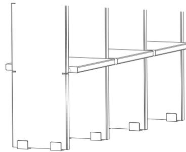
Zur exakten Positionierung der FNP Ausgleichskeile bei unebenen Böden.
