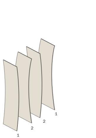
**Hinweis:** Regalseiten aus FU (Sperrholz, Birke) können sich durch klimatische Bedingungen leicht verformen. Im Verbund mit Schienen und Fachböden gleicht sich die Wölbung später aus. Ggf. äußere Regalseiten mit der Wölbung zur Regalmittle hin aufstellen (1), innere Seiten mit Wölbung gegenläufig zueinander positionieren (2).
